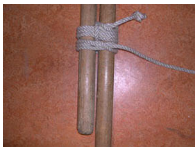
4a) Surningen avslutad runt båda stängerna.
